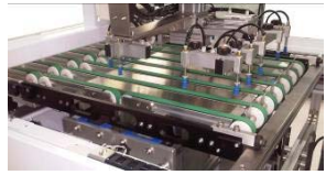
PCB Picker and Contactless Centering PCB 提取臂 和 非接触式定心机构
